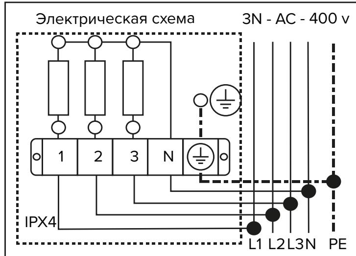
Электропроводка для печи и все электрические соединения должны быть сделаны с помощью кабелей, стойких к температуре не ниже 170 °C. Тип кабеля: РКГМ, ПВКВ, ПРКС. Сечение согласно мощности. Смотрите таблицу на странице 9.
