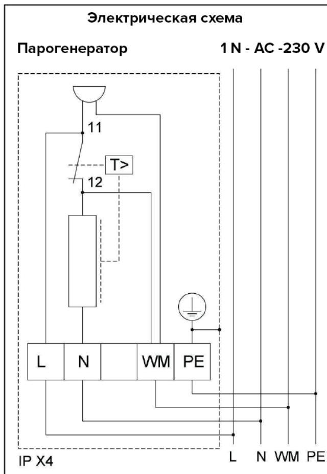
Схема подключения парогенератора электрокаменки соответствует данной иллюстрации.
